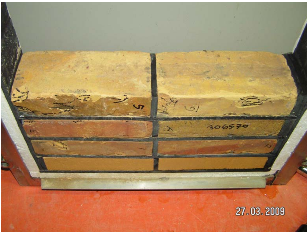
Testpanel under adskillelse efter frost.
