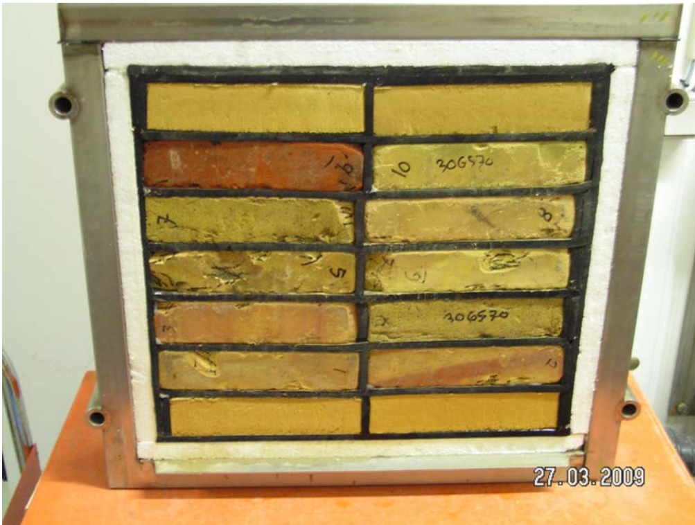
Testpanel efter frost.
